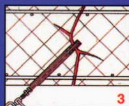
ABDICHTEN EINES RISSES AN EINER BETONKONSTRUKTION
